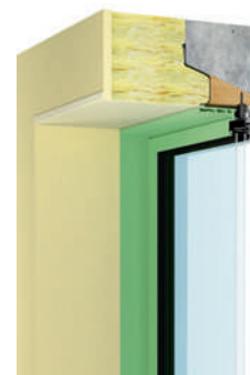
Isolation thermique par l'extérieur (ITE)
